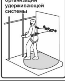
Рис. 15. Способ организации удерживающей системы
