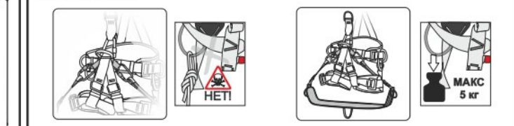
Рис. 18. Способ интеграции рабочего сидения
