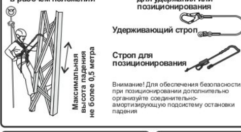
Рис. 17. Пример организации системы канатного доступа
