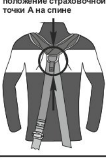
Рис. 10. Правильное положение страховочной точки А на спине
