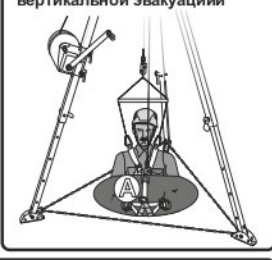
Рис. 16. Способ проведения вертикальной эвакуации
