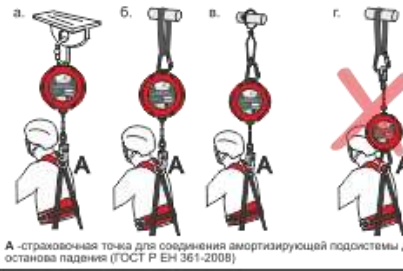
Рис. 5. Общие принципы использования карабинов
