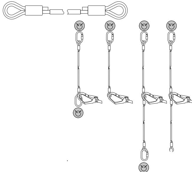
Рис. 4. Допустимое распределение нагрузок
